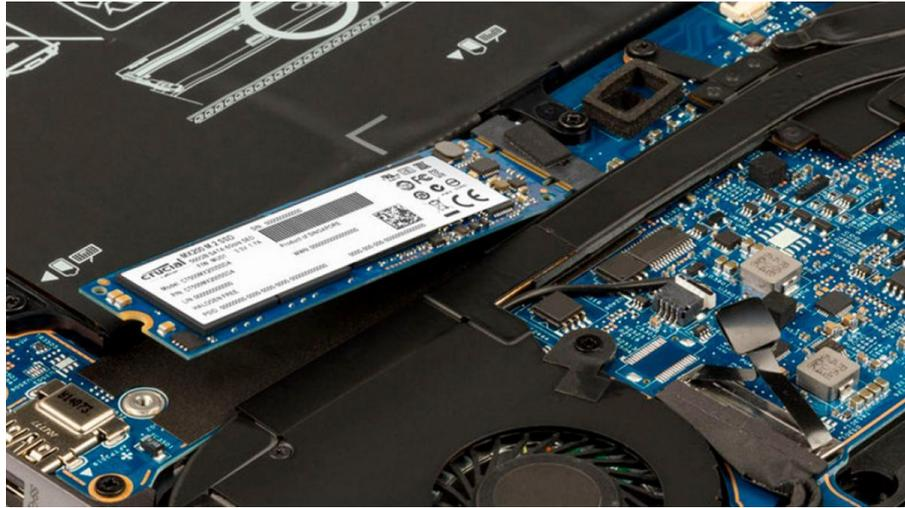
*[Imagen](#) SSD con conexión M.2*
