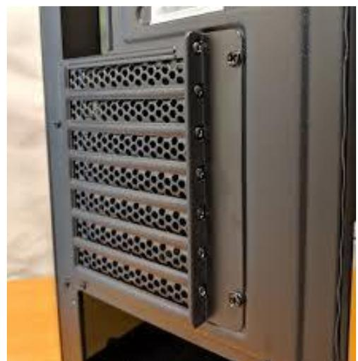
*Imagen* Extracción chapa metálica caja
